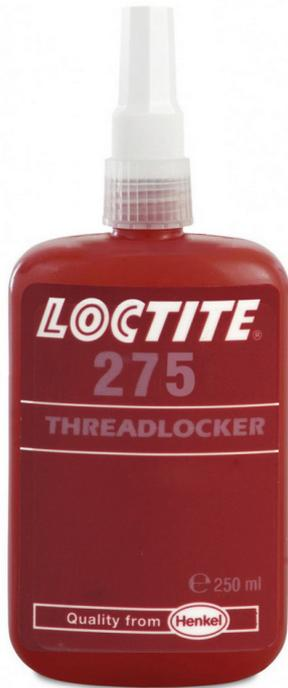
**DESCRIZIONE:** LOCTITE® 275 è formulato per bloccare e sigillare in modo permanente i giunti filettati. Il prodotto polimerizza in assenza di aria e a contatto con metallo prevenendo l'allentamento dovuto ad urti e vibrazioni. Le applicazioni tipiche includono anche il bloccaggio e la sigillatura di bulloni e prigionieri di dimensioni elevate (M25 e oltre).
